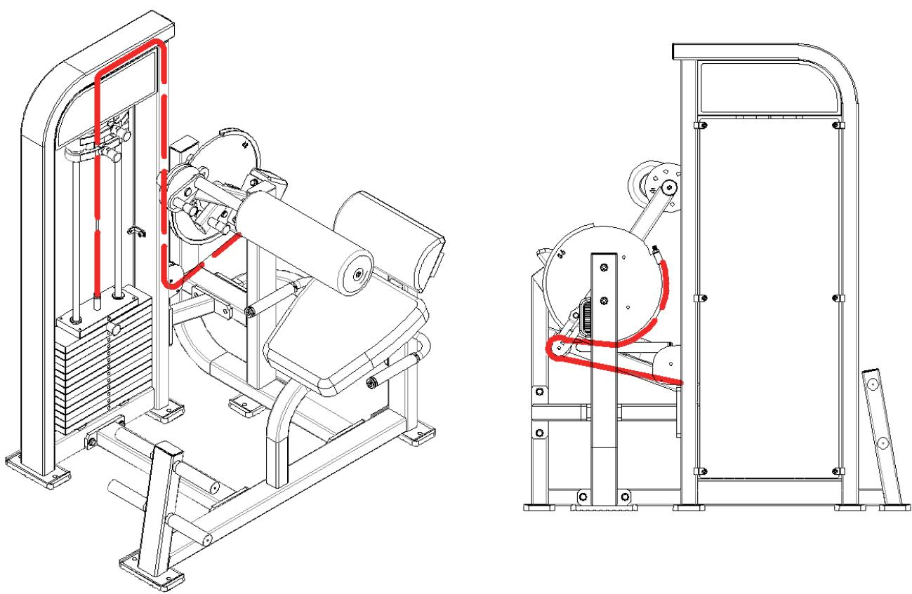
Схема протяжки троса
