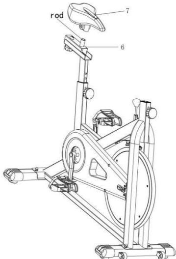
Наденьте сиденье (7) на соединительную деталь (6). Плотно задейте его, затянув две гайки под сиденьем (7).
