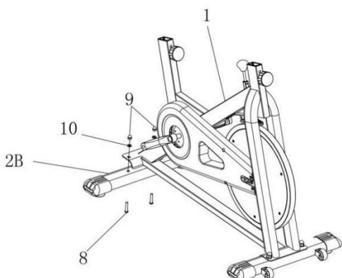
Закрепите задний стабилизатор (2В) на основной раме (1), используя 2 комплекта каретных болтов (8), купольных гаек (9) и шайб (10).
