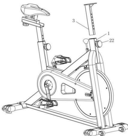
Ослабьте ручку регулировки (22) и вставьте деталь регулировки руля (3) в основную раму (1). Убедитесь, что отверстие расположено на одном уровне с ручкой регулировки (22), и затяните ее (22).
