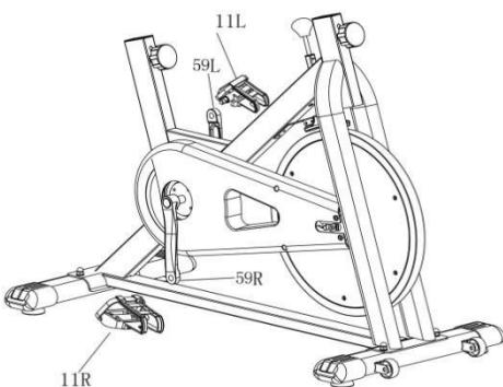
Вставьте правую педаль (11R) в коленчатый вал (59R) и закрепите, вращая ПО ЧАСОВОЙ СТРЕЛКЕ. Закрепите левую педаль (11L) в коленчатом вале (59L), вращая ПРОТИВ ЧАСОВОЙ СТРЕЛКИ. Используйте гаечный ключ (20) для надежной фиксации крепления.
