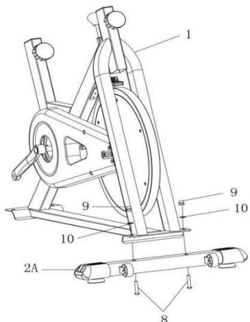
Закрепите передний стабилизатор (2А) на основной раме (1), используя 2 комплекта каретных болтов (8), купольных гаек (9) и шайб (10).
