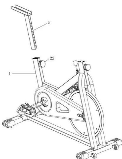
Ослабьте ручку регулировки (22) и вставьте деталь регулировки сиденья (5) в основную раму (1). Убедитесь, что отверстия лежат на одной прямой, и затяните ручку регулировки (22).
