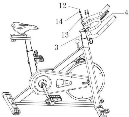
Соедините руль (4) и деталь регулировки руля (3). Убедитесь, что отверстия совпадают полностью. Надежно скрепите детали 4 комплектами шестигранных болтов (12), шайб (13) и пружинных шайб (14).
