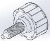
22. Ручка регулировки М16 | 31 Шайба $\varnothing 10.5 * \varnothing 20$ |
