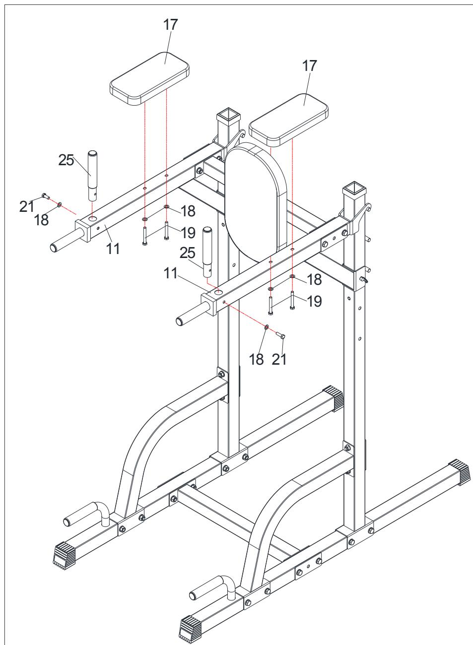
8. Установите рукоятки (25) на крепёжные балки (11), закрепите их с помощью болтов M8\*20 (21) и шайб Ø8 (18).
