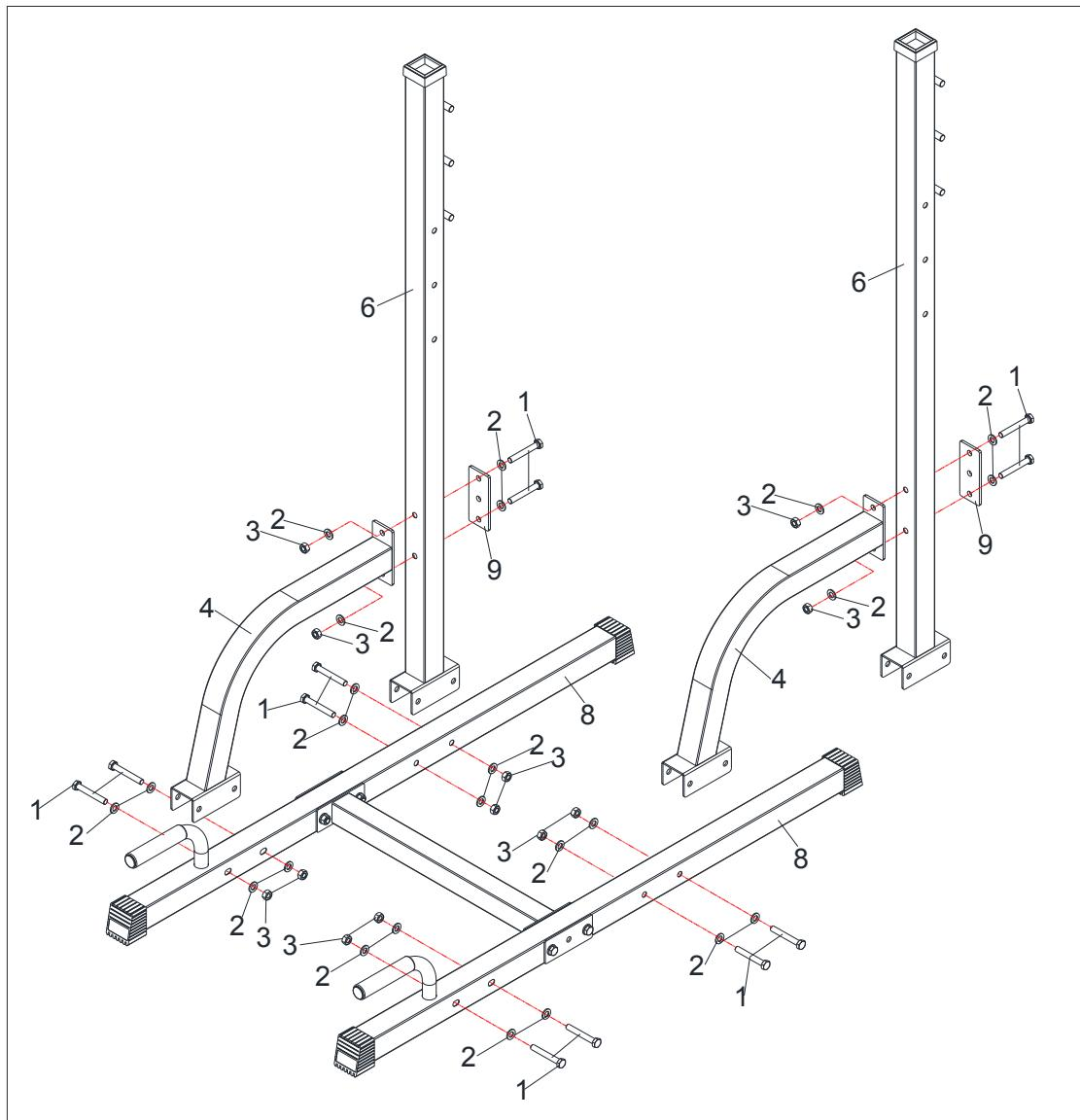
2. Установите стойку (6) поверх стабилизатора(8), закрепите её с помощью болтов M10\*70, (1) шайб Ø10, (2) и нейлоновых гаекM10 (3).
