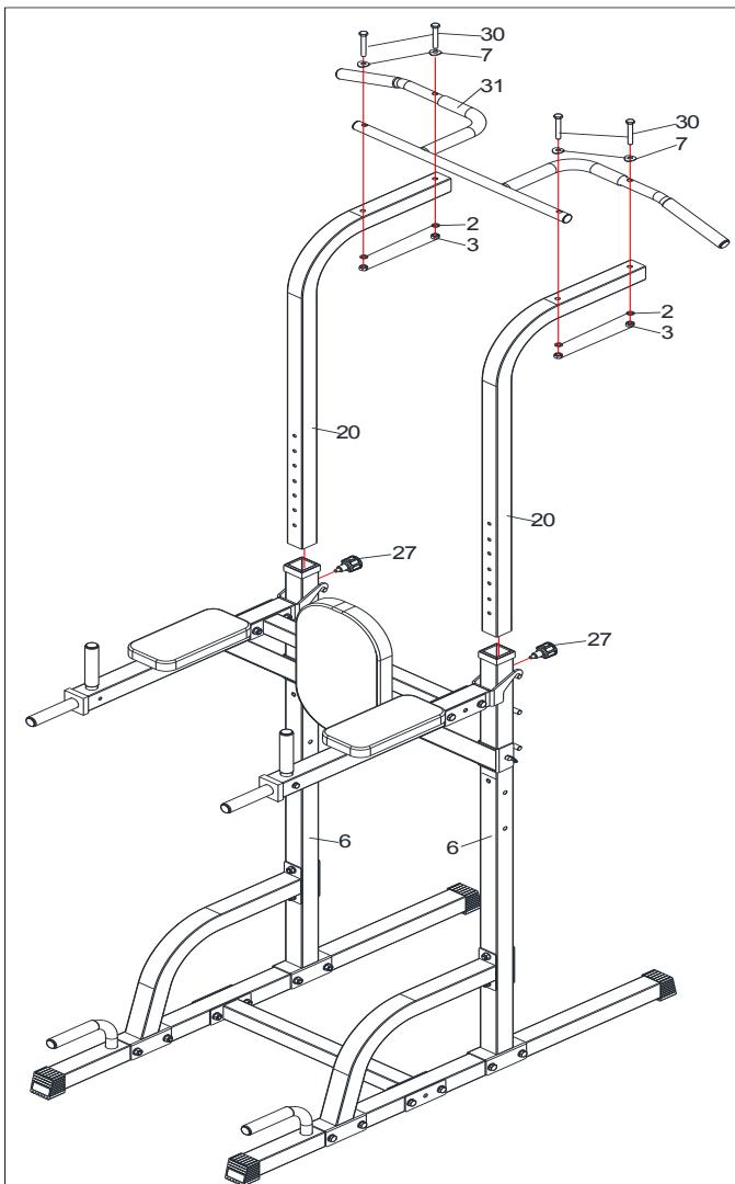
10. Соедините верхние и нижние части стоек, отрегулируйте их по высоте и зафиксируйте положение с помощью регулировочных ручек (27).
