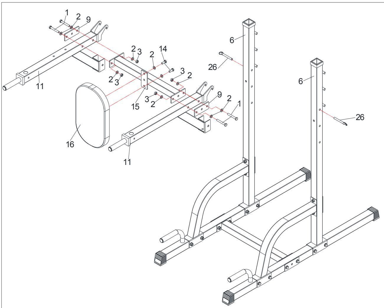
5. Прикрепите крепёжные балки (11) к стойкам (6) с помощью двух стопорных штифтов (26).
