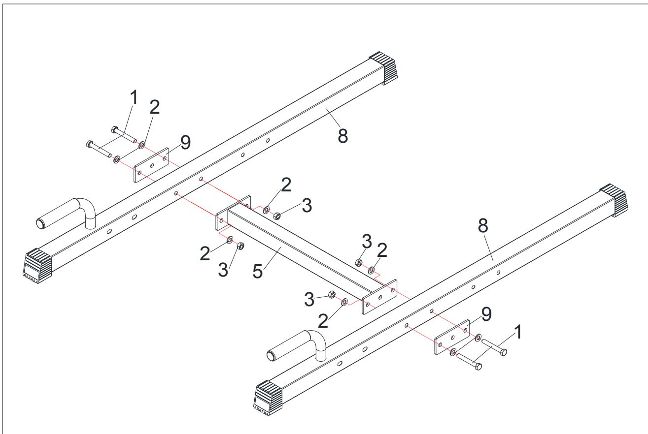
1. Расположите соединительную перекладину (5) между стабилизаторами (8), после чего зафиксируйте полученную конструкцию с помощью болтов M10\*70 (1) шайб Ø10 (2) нейлоновых гаек M10 (3) и крепёжных пластин (9).
