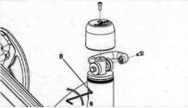
Снимите регулятор вращения движения шатунов. Расцепите кулачковый механизм (С), повернув его против часовой стрелки на 1/8 оборота(D), затем соедините обратно. При необходимости повторите еще раз, чтобы ручка верхнего привода «не болталась». Регулятор вращения движения шатунов должен оставаться подвижным, если он двигается слишком туго, повторите предыдущий шаг.
