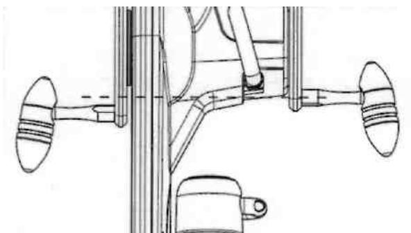
Поверните регулятор нагрузки на «+», чтобы шатуны сами приняли самое нижнее положение. Поднимите шатуны, чтобы выровнять ручки вращения. Ослабьте (не снимайте) 5 винтов(В) на правом шатуне с помощью 4мм торцевого ключа. Отрегулируйте положение винтов в отверстиях на обеих ручках, выровняйте последние и затяните. Убедитесь, чтобы все винты были хорошо затянуты, иначе ручка может «вылететь» снова.
