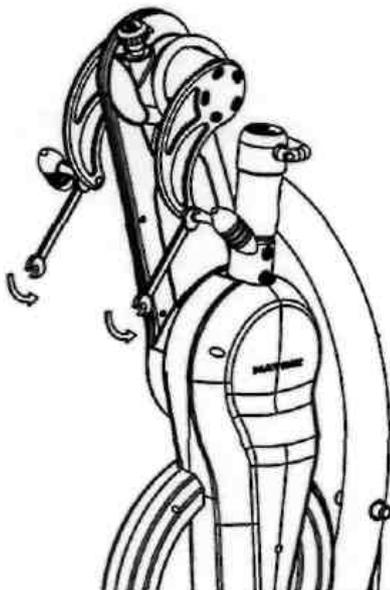
6. Затяните плотно рукоятки с помощью 15 мм ключа.
