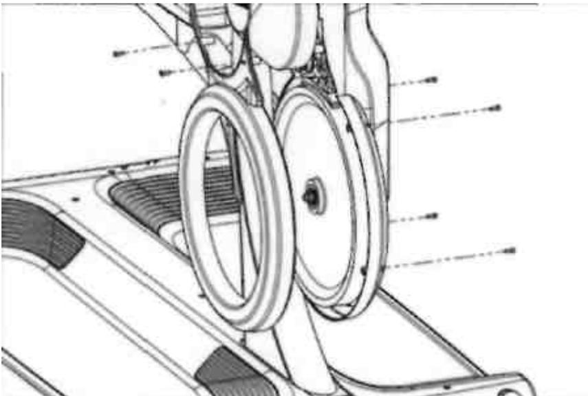
Ослабьте( не снимайте) тормозной винт (С) и поверните регулятор нагрузки на «+» до конца. Далее поверните регулятор нагрузки на «+» 1. Убедитесь, что тормозные колодки прижаты к маховику и закрепите тормозной трос под винтом(С). Поверните регулятор нагрузки на «-» - расстояние между маховиком и тормозной колодкой должно составлять 1-2мм.
