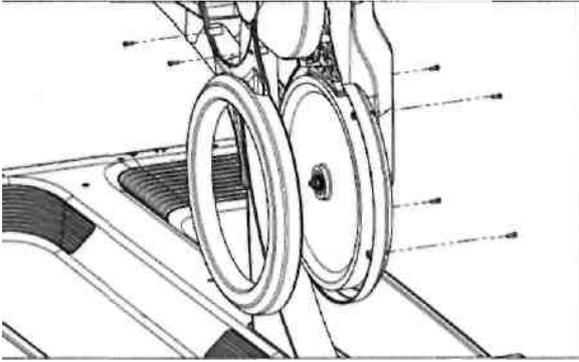
Б. Проверьте тормозные колодки . Поверните регулятор нагрузки на «-», таким образом установив минимальный тормозной эффект. Расстояние между тормозными колодками и маховиком должно быть 1-2 мм. Тормозные колодки должны быть плотно прижаты к своей оси. Если необходимо настроить тормозные колодки смотрите пункт 6.5 НЕИСПРАВНОСТИ.
