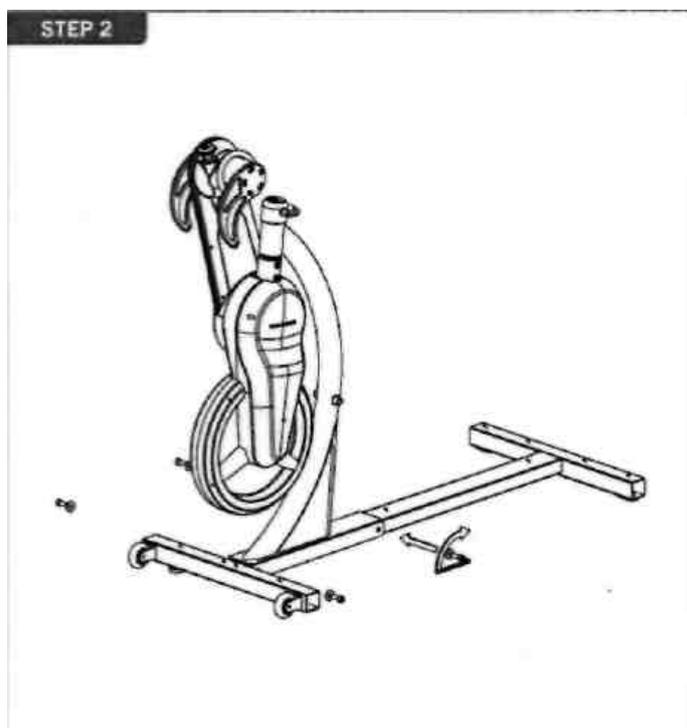
2. Закрепите раму маховика на основной раме, используя 8мм ключ-шестигранник, 1 плоскую шайбу и 2 болта с цилиндрической головкой.
