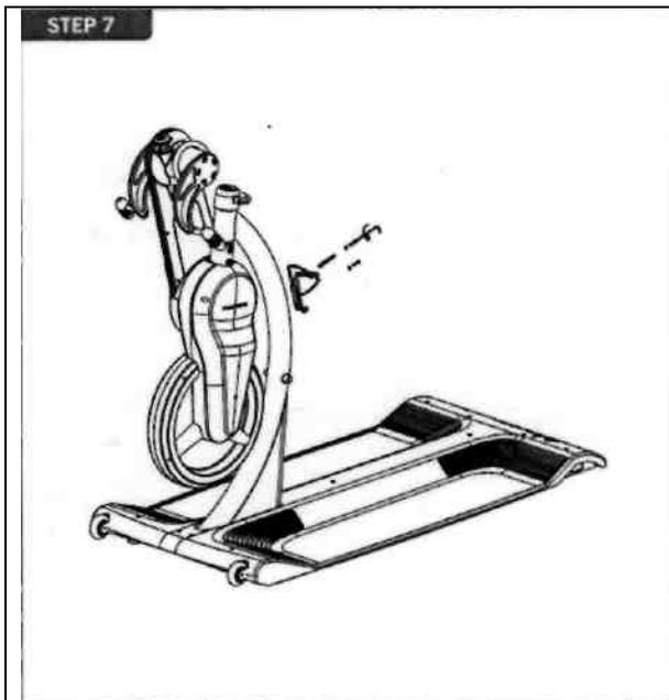
7. Закрепите держатель для фляги в центре рамы маховика с помощью 4мм ключа шестигранника и болта с цилиндрической головкой
