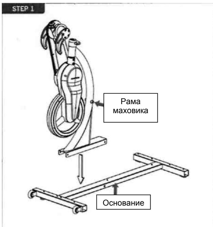
1. Установите раму маховика на основании, зафиксировав отверстия для болтов на рамах.
