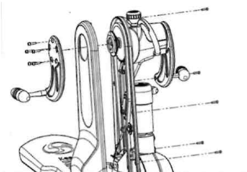
Снимите правый шатун (открутите 5 винтов 4мм-торцевым ключом), затем удалите пластиковый кожух (5 винтов 3мм торцевым ключом).
