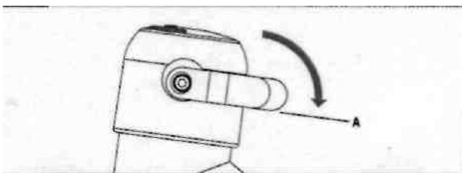
Снимите регулятор вращения и крышку, открутив 2 винта 4мм-торцевым ключом. Ослабьте(не снимайте) 3мм-торцевым ключом винт (В).
