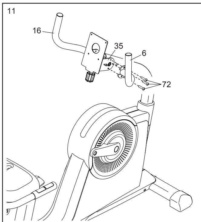
12. Пока ваш помощник удерживает консоль (13) рядом с кронштейном (35), протолкните провода консоли в отверстие, расположенное в центре кронштейна.
