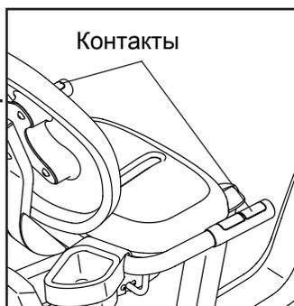
**Когда ваш пульс будет зафиксирован, он появится на экране. Для наиболее точного определения частоты пульса, держитесь за контакты около 15 секунд.**
