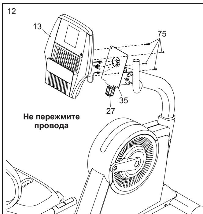
13. Найдите самый длинный провод консоли (13). Вставьте этот провод в верхнюю часть стойки (4) и вытащите его через указанное отверстие.
