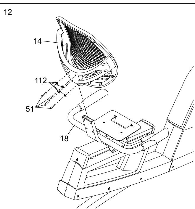
13. Прикрепите сиденье (12) к рукоятке сиденья (18) с помощью четырех винтов M6 x 20mm (67) и четырех шайб M6 (112) (показаны только два из них); **вставьте винты, затем затяните их.**
