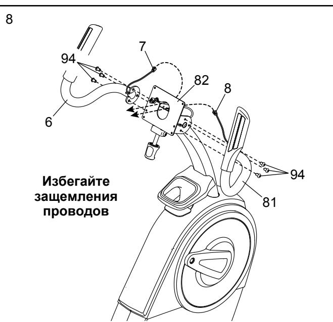
9. Пока второй человек держит консоль (5) рядом с креплением консоли (82), подключите основной провод (41) и проводы левого и правого пульсометра (7,8) к приемнику на консоли.
