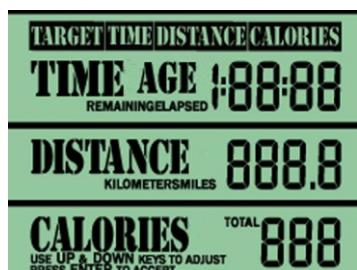
В секции дисплея «Целевое значение» отображаются значения времени, расстояния и калорий в течение всех программ тренировки. В верхней части дисплея отображается выбранного параметра. В секции «Время» может отображаться как время, оставшееся до конца тренировки, так и время, прошедшее с начала тренировки. Общее расстояние отображается в милях или километрах в зависимости от настроек консоли.
