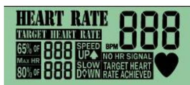
В этой секции дисплея отображается информация, связанная с частотой пульса пользователя.
