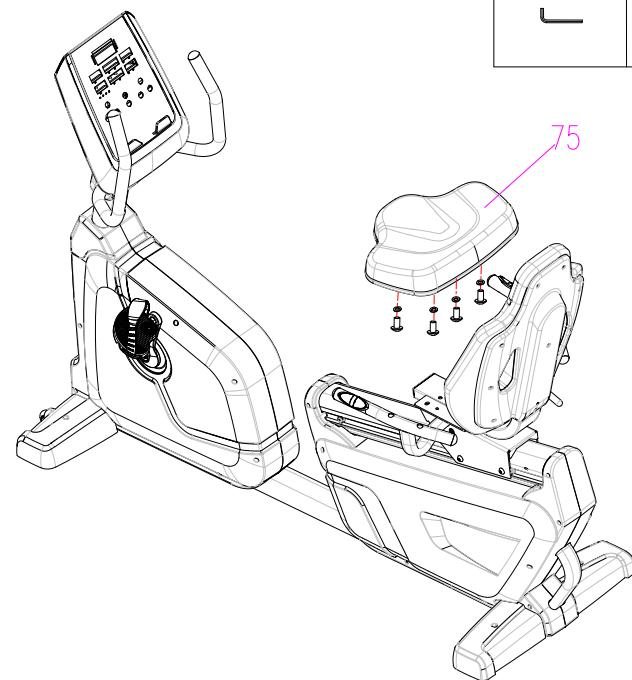
Установите сиденье (75) и зафиксируйте его предустановленными болтами.
