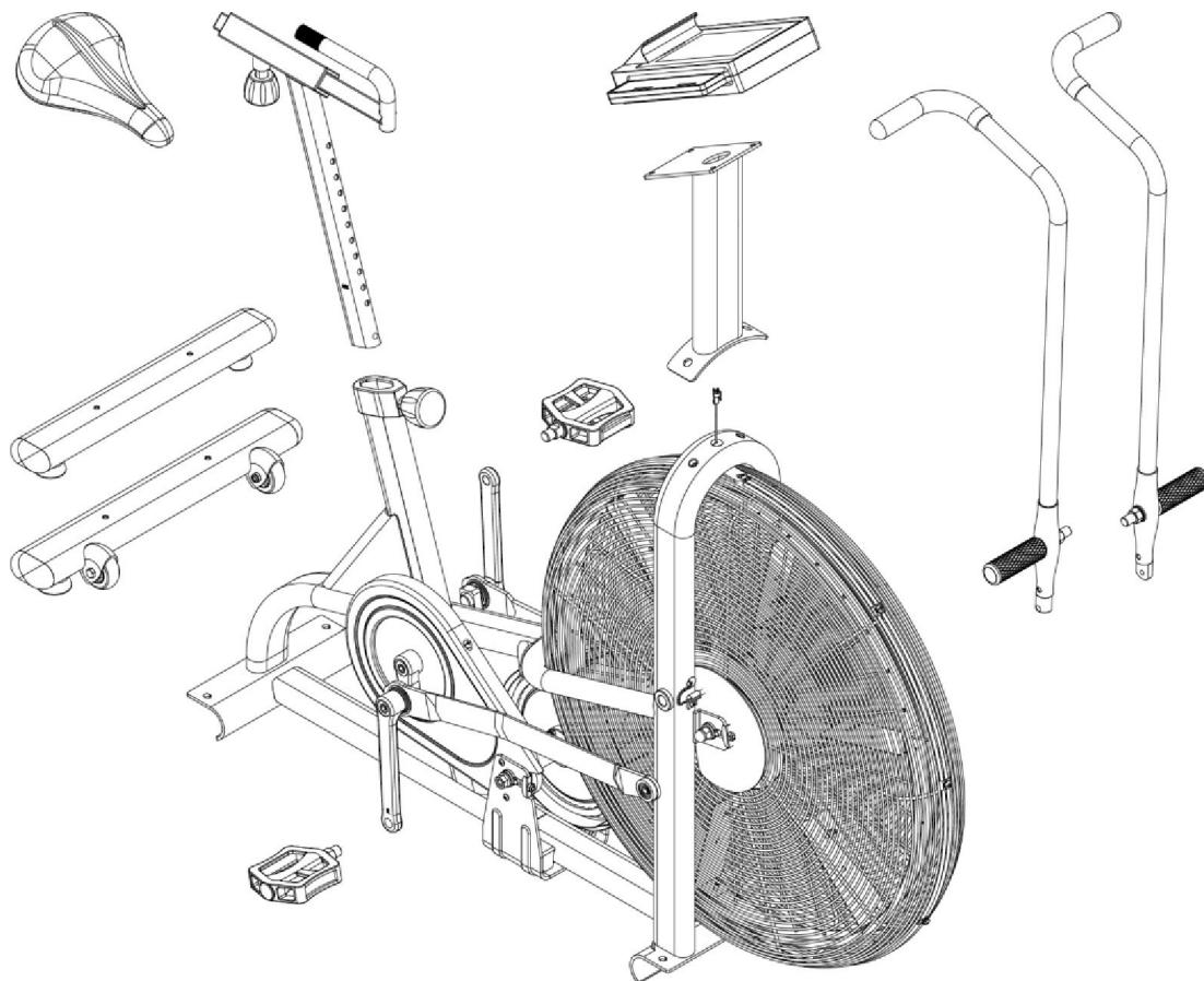
1. Соедините переднюю опору с основной рамой, и установите два винта, стопорную шайбу и плоскую шайбу с помощью прилагаемого бмм шестигранного ключа.
