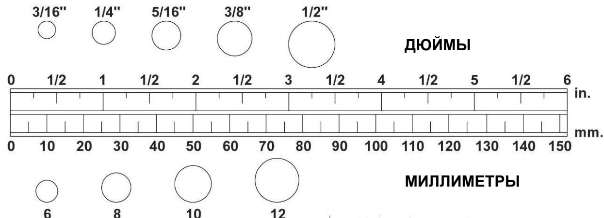
**ПРИМЕЧАНИЕ:** Длина болтов и винтов, кроме единиц с плоской головкой, измеряется от нижней части головки до конца болта или винта. Болты и винты с плоской головкой измеряются от верхней части головки до конца болта или винта.
