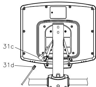
d. Закрепите **Консоль** (31) на **Стойке консоли** (33) и полностью затяните 4 Круглых винта (**M6xp1.0x15мм**) (135).
